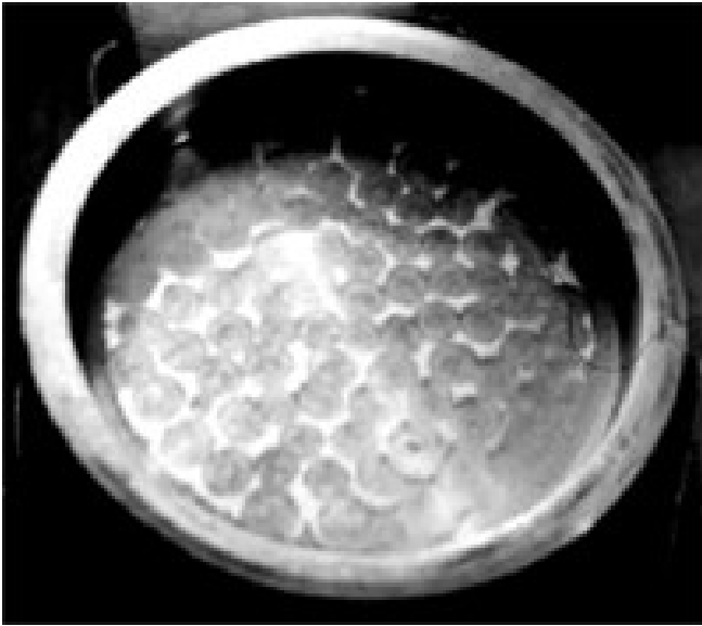
Рис. 1.20. Упорядковані шестикутні структури на дні сковорідки (комірки Бенара) – приклад самоорганізації в лабораторних, точніше кухонних умовах.
